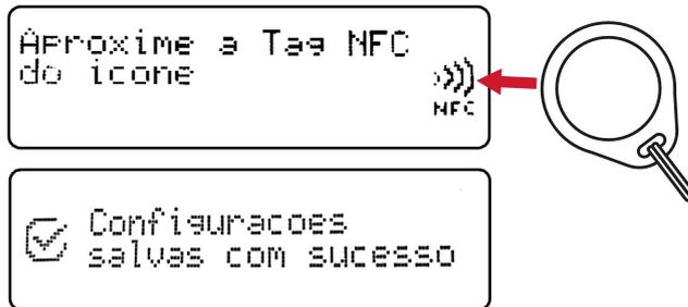
Caso a tag NFC não for reconhecida, ou o tempo de reconhecimento da tag NFC expirar e não for o suficiente para gravar a tag, aparecerá no tacógrafo uma mensagem de falha seguida de dois beeps curtos de erro.
