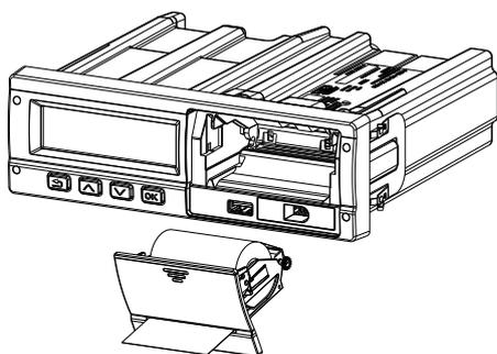
**3-** Coloque a bobina da fita diagrama dentro da bandeja da impressora respeitando a orientação do papel conforme abaixo. Lembre-se de passar o papel entre a abertura com serrilha da tampa da bandeja, deixe cerca de 5mm do papel para fora da tampa.
