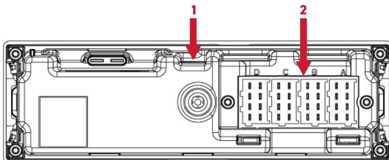
(1) Pino guia antivibração revestido com borracha, compatível com gavetas no formato 1 DIN
