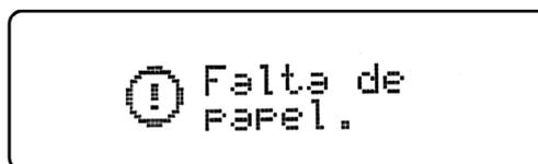
**Bobina de fita diagrama mal inserida** →. Se a bobina de fita diagrama for mal inserida na gaveta bandeja da impressora, e o motorista tentar realizar a impressão, a impressora terá dificuldades para puxar o papel ou o papel pode enroscar na saída da tampa da gaveta, caso isso ocorra aparecerá uma tela informando que o rolo de papel está mal inserido.
